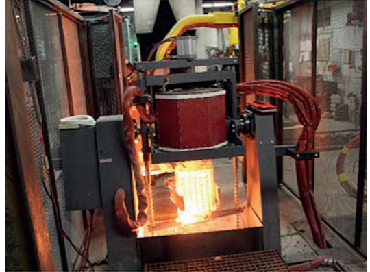
Two firing and melting lines with 25kg roll over and from 120 to 180 kg conventional furnaces Double ligne de cuisson et fusion avec four à retournement de 25kg et conventionnels de 120 à 180kg
