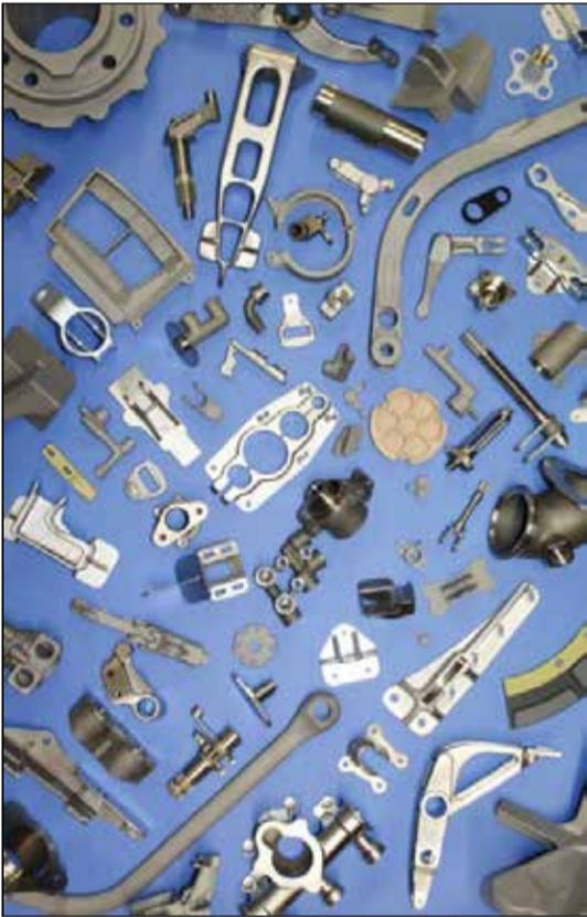
**PRECIMETAL** produit des pièces de fonderie brutes ou complètement terminées (y compris usinage, traitements de surface, assemblages, ...) prêtes à l'emploi directement sur chaînes de montage.
